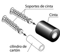
c) Instale la cinta sin utilizar y el soporte en la parte posterior del módulo de transmisión de cinta. Los ejes de Transmisión del mecanismo del engranaje de la transmisión de la cinta encajan en el extremo del soporte de cinta.
