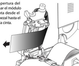
e) Utilice el extremo adhesivo de la cinta de impresión, o bien cinta adhesiva convencional, para sujetar la cinta que acaba de extraer en el soporte de cinta en el que se ha fijado el tubo de papel, y enróllela en el soporte de cinta.
