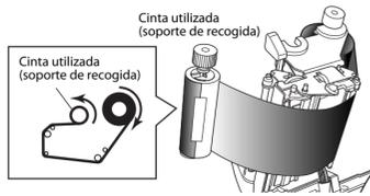
f) Ponga el soporte de cinta al que se le ha fijado el tubo de papel en el módulo de transmisión de cinta, gire a continuación en el sentido mostrado por la flecha para eliminar la parte floja y las arrugas de la cinta.
