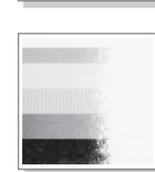
La primera muestra, a la izquierda, indica un "ajuste de grosor de material" inadecuado. Para material de impresión de etiquetas estándar, es recomendable situar el dial azul en la posición "0".
