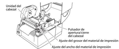
i. Con la alimentación activada, apriete la tecla FEED para que se suministre material de impresión. Éste se detendrá en la siguiente posición de inicio de impresión.
