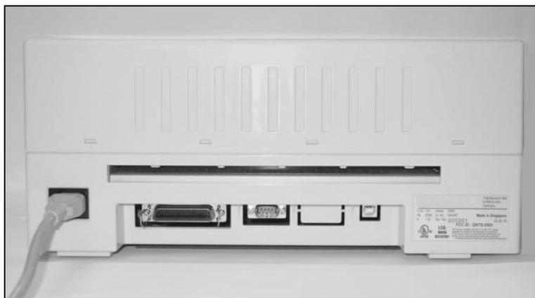
Collegare il cavo di alimentazione alla presa di alimentazione nella stampante. Collegare il connettore del cavo di alimentazione a una presa di corrente.
