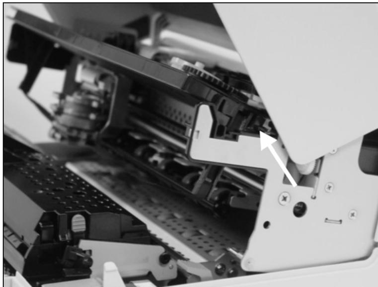
Inserire la nuova cartuccia agganciandola negli alloggiamenti posteriori del dispositivo di montaggio.
