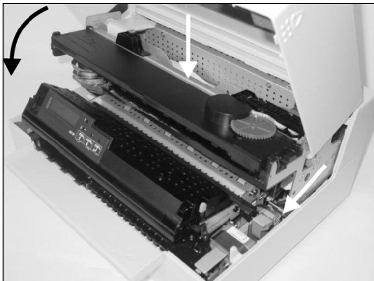
Chiudere il telaio principale premendo la sezione colorata al centro come indicato e controllare che entrambi i lati sinistra e destra del telaio sia completamente bloccati.
