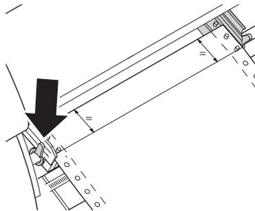
Rilasciare la levetta verde e disporre il trascinamodulo in modo da far coincidere la posizione di stampa sulla carta con il contrassegno **X** presente sulla custodia della stampante. Richiudere la levetta verde. Agganciare i moduli continui al trascinamodulo sinistro.
