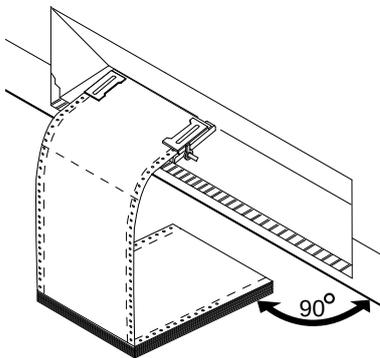
Fare attenzione a collocare la pila dei moduli continui parallelamente alla stampante per evitare interferenze con l'alimentazione carta. Richiudere il coperchio superiore.
