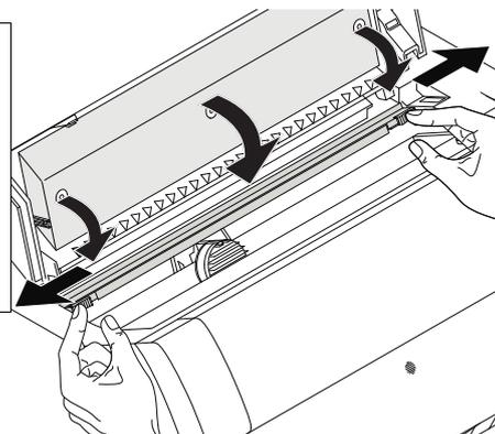
Spingere la guida di inserimento **A** verso il basso. Muovere la testina a destra e a sinistra per tendere il nastro inchiostro verificando che venga riavvolto. Spingere la frizione verso il basso per fissarla. Richiudere il coperchio superiore della stampante.
