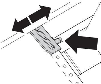
Rilasciare la levetta verde del trascinamodulo destro e posizionarlo in funzione della larghezza della carta. Agganciare i moduli continui al trascinamodulo destro. Fare attenzione a rispettare la stessa altezza del trascinamodulo sinistro, altrimenti si rischia di provocare inceppamenti. Richiudere il trascinamodulo e bloccarlo portando la levetta all'indietro.
