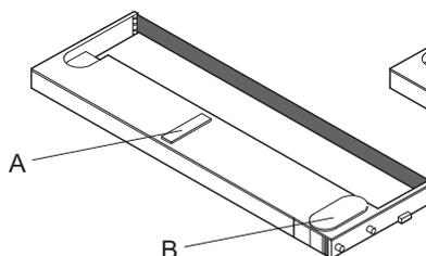
Rimuovere i fermi di sicurezza verde **A** e **B**. Inserire la manopola verde sul nastro inchiostro, inserirla a destra e ruotarla nella direzione della freccia per riavvolgere il nastro inchiostro.
