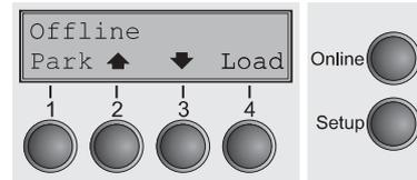
Soltanto in questa modalità è possibile comandare l'avanzamento passo-passo, riga per riga o della modulistica attraverso il pannello comandi non è possibile la ricezione dei dati.
